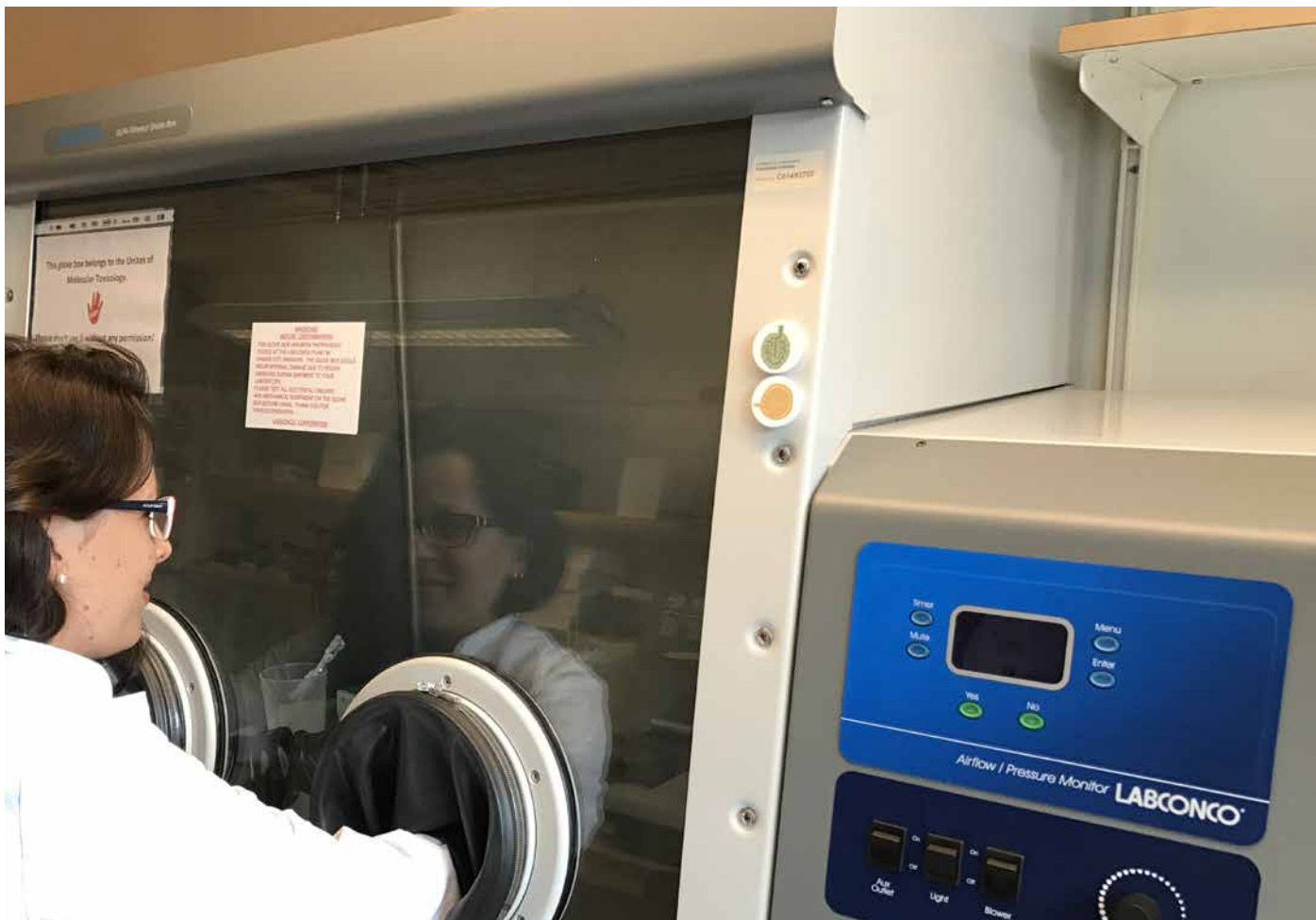
Katharina Klöditz på Institutet för miljömedicin vid KI jobbar i en så kallad glove box, där nanomaterial i pulverform kan hanteras i en sluten låda med behandskade händer.
